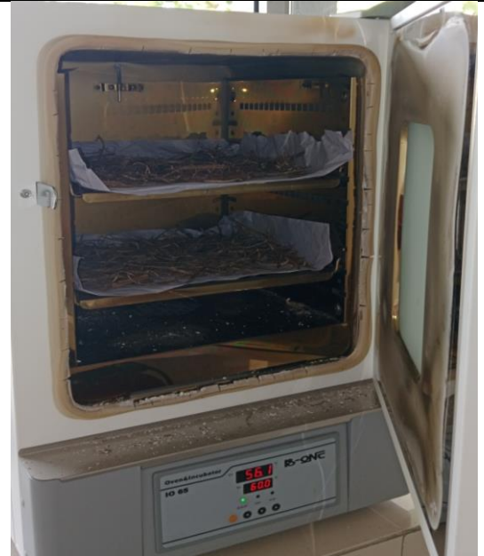
Pengeringan kulit batang kersen menggunakan oven
