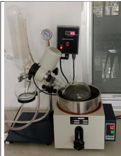
Penguapan filtrat menggunakan rotary evaporator.
